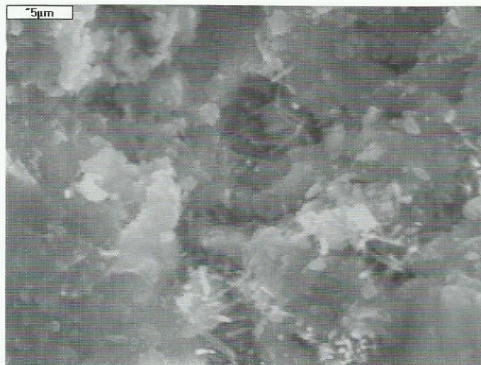
Rys. 4. Zaczyn bez dodatku, po 28 dniach twardnienia. Widoczna żelowa faza C-S-H oraz ettringit
