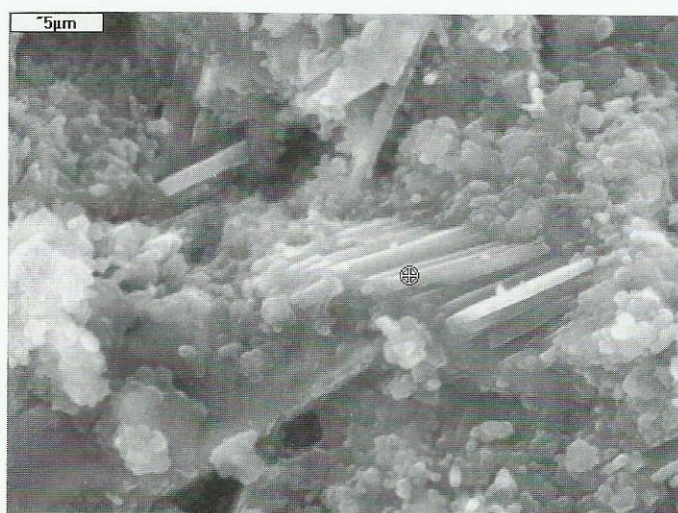
Rys. 3. Zaczyn bez dodatku, po 2 dniach twardnienia. Widoczna zbita faza C-S-H oraz kryształy portlandytu. Poza tym w lewym górnym rogu widoczne pręciki ettringitu
