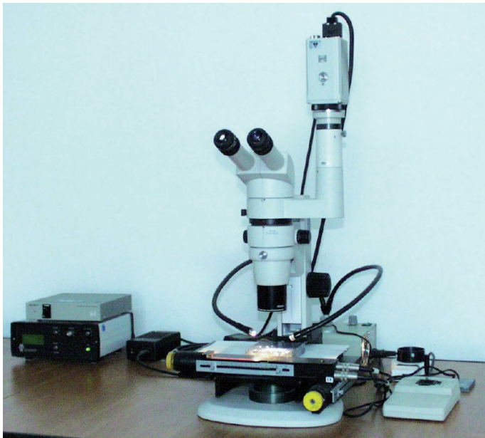
Rys.1. Widok stanowiska do automatycznej analizy rozmieszczenia porów w betonie
