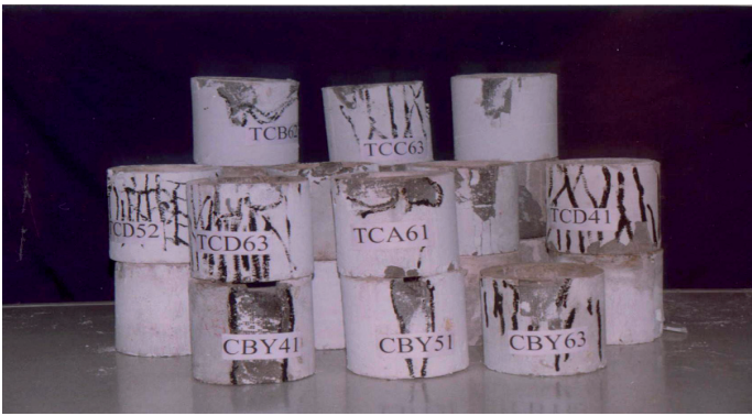
Rys. 5. Obraz spękań próbek (metoda a)
