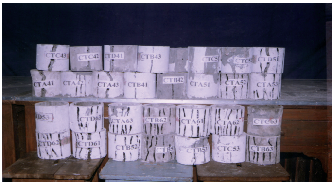
Rys. 6. Obraz spękań próbek (metoda b)
