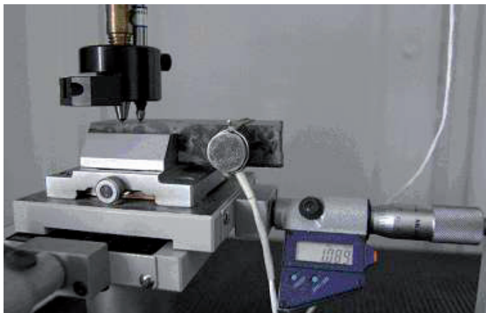
Rys. 2. Sensor EA umieszczony przy bocznej powierzchni próbki betonowej
