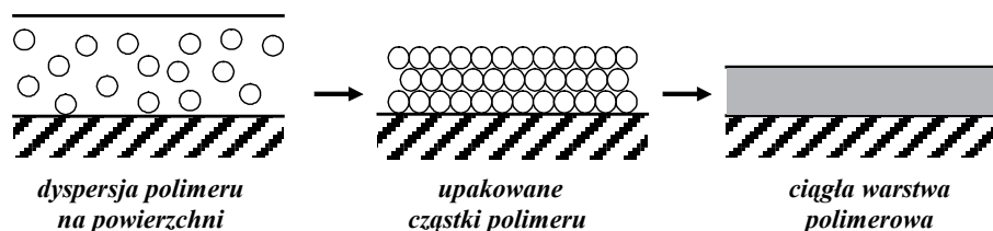
Rys. 2. Powstawanie ciągłej błonki polimeru, wg (3)
