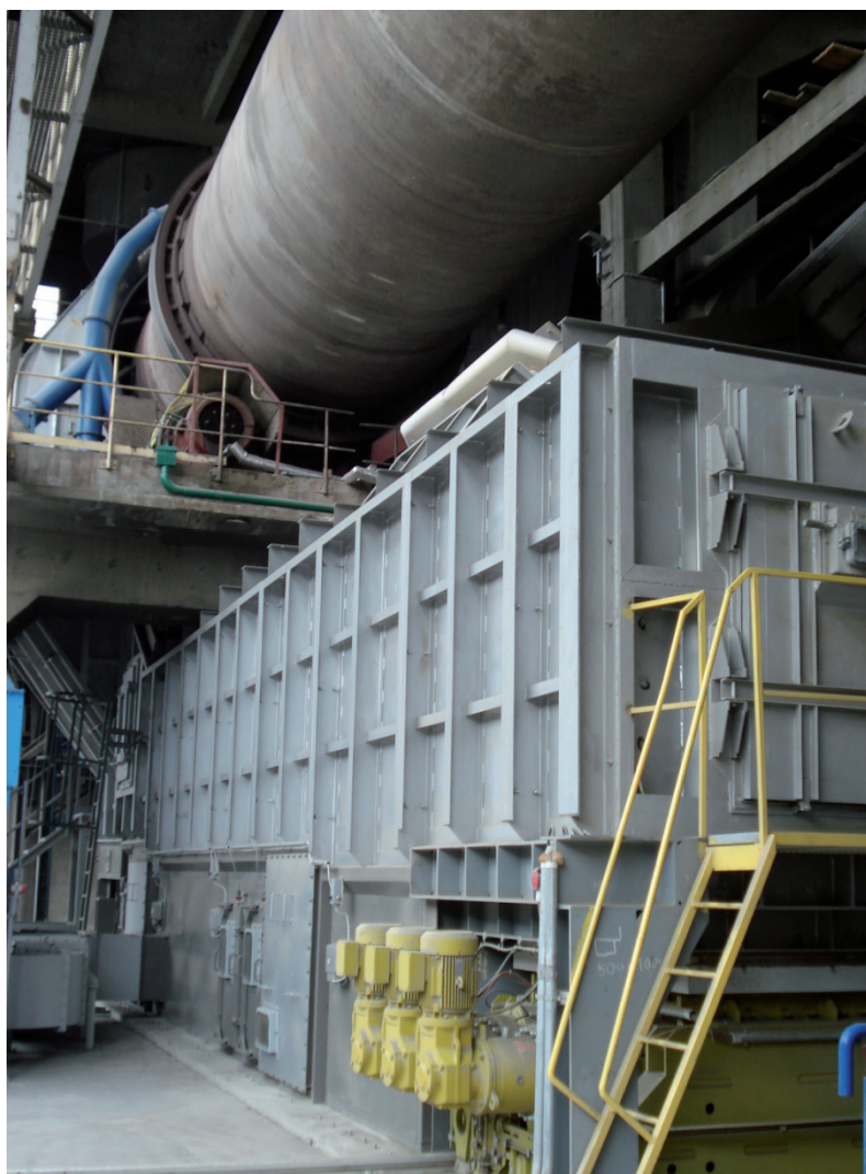
Fot. 11. Chłodnik rusztowy klinkieru
