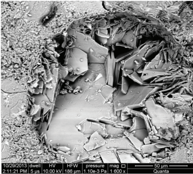
Rys. 5. Pustka wypełniona częściowo kryształami portlandytu
