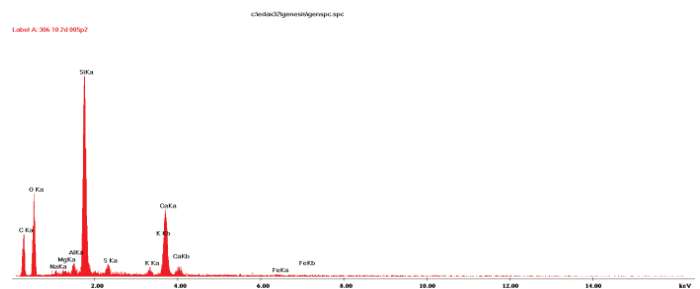
Rys. 10.1. Mikroanaliza rentgenowska w punkcie 1 zaznaczonym na rys. 10 Fig. 10.1. EDS analysis in point 1, Fig. 10
