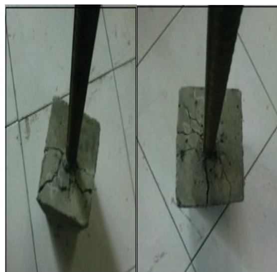
Rys. 5. Uszkodzenia próbek po badaniach
