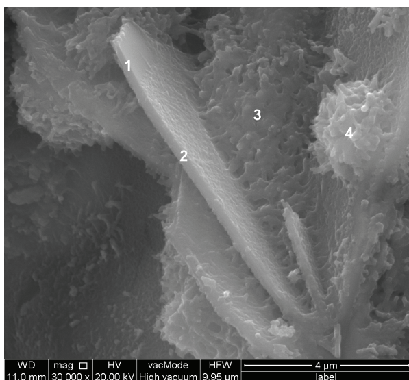
Rys. 15. Mikrostruktura zaczynu cementowego bez pyłu bazaltowego po 5h hydratacji
