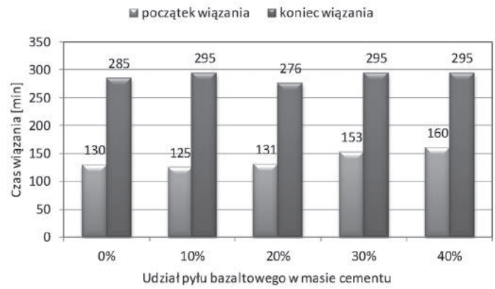
Rys. 23. Wpływ pyłu bazaltowego na czas wiązania cementu
