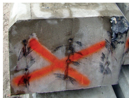
Rys. 8. Rozszczepienie podrozdznicy kolejowej, sprężonej drutami Fig. 8. Splitting for railway bearer prestressed with wires
