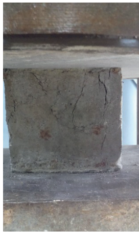
Rys. 1. Schemat zniszczenia betonu ECC
