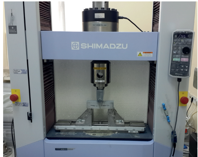
Rys. 2. a) Kąt zwilżania modyfikowanego powierzchniowo tworzywa odpadowego PP (b) Prasa wytrzymałościowa Shimadzu
