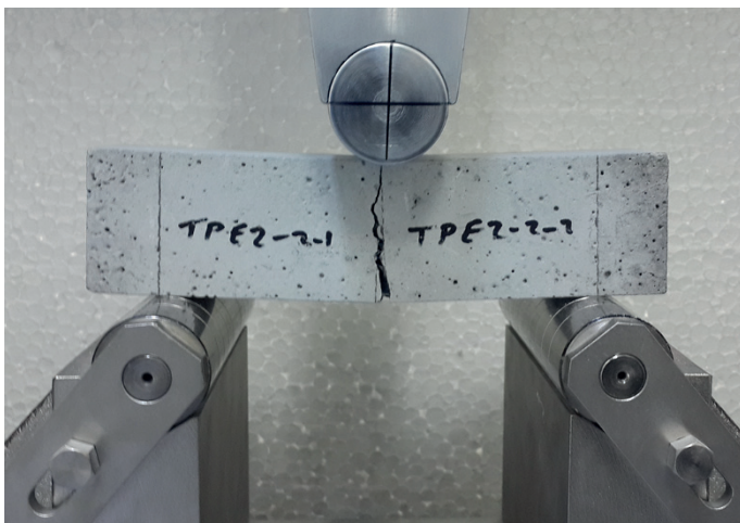
Rys. 3. Zniszczenie próbki zaprawy podczas badania wytrzymałości na zginanie
