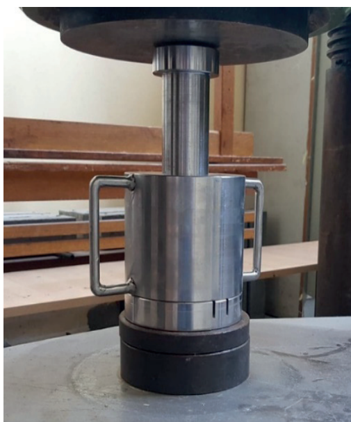
Rys. 3. Urządzenie do pobierania fazy ciekłej metodą ekstrakcji ciśnieniowej
