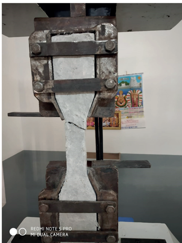
Rys. 6. Typowe zniszczenie próbki w kształcie kości
