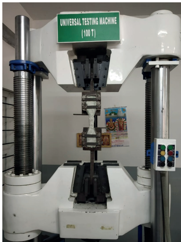
Rys. 3. Badanie wytrzymałości na rozciąganie oraz szczegółowe wymiary próbki w kształcie kości
