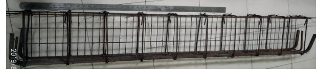
Rys. 4 (d). Belka L160 - konwencjonalny układ wzmocniony wzdłużnie siatką stalową
