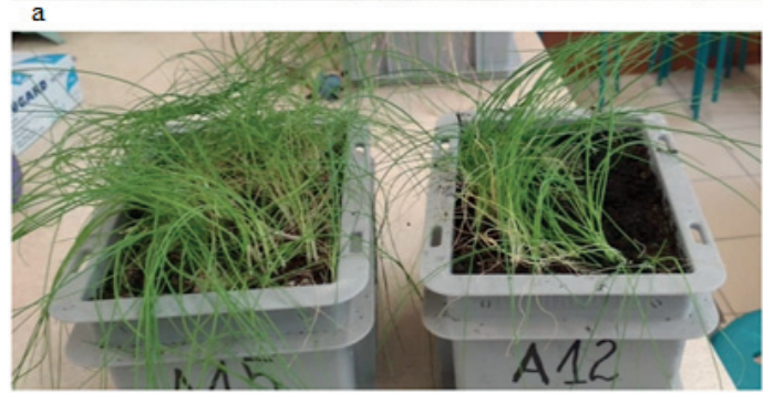
Rys. 10. Wygląd próbek po 180 dniach wzrostu. a – próbki żyta; b – próbki szczypioru; po lewej uprawy z zaprawą z alkalicznie aktywowanego spoiwa żużlowego, po prawej uprawy z zaprawą z cementu portlandzkiego
