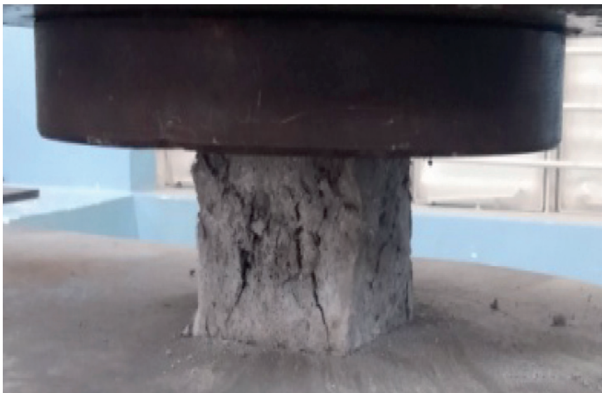
Rys. 4. Typowy obraz zniszczowej próbki IKC
