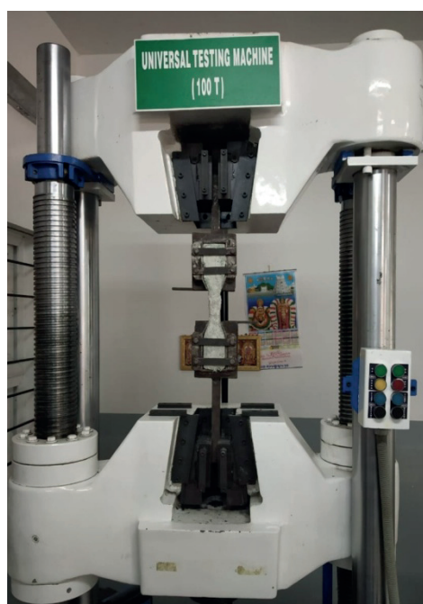
Rys. 2. Pomiar wytrzymałości na rozciąganie z zastosowaniem próbki w kształcie psiej kości
