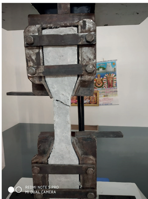
Rys. 6. Typowy obraz zniszczenia próbki w kształcie „psiej kości”
