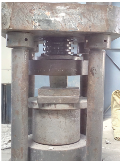
Rys. 1. Próbką sześcienną w trakcie badania wytrzymałości
