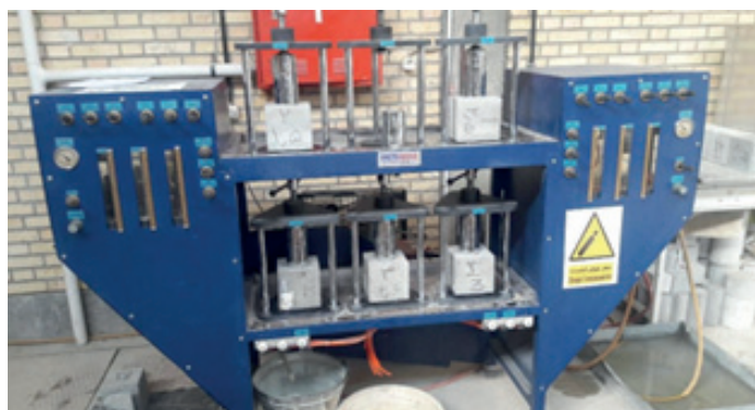
Rys. 2. Stanowisko do badania głębokości penetracji wody pod ciśnieniem
