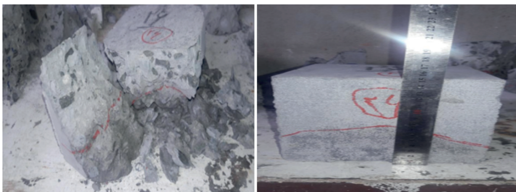
Rys. 3. Głębokość penetracji wody pod ciśnieniem – sposób mierzenia odległości od powierzchni próbki
