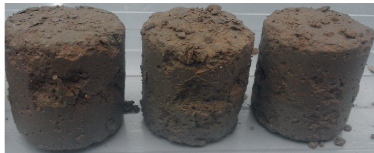
b) Pg stabilizowany spoiwem drogowym A w ilości 7% / Pg stabilised with road binder A at 7%
