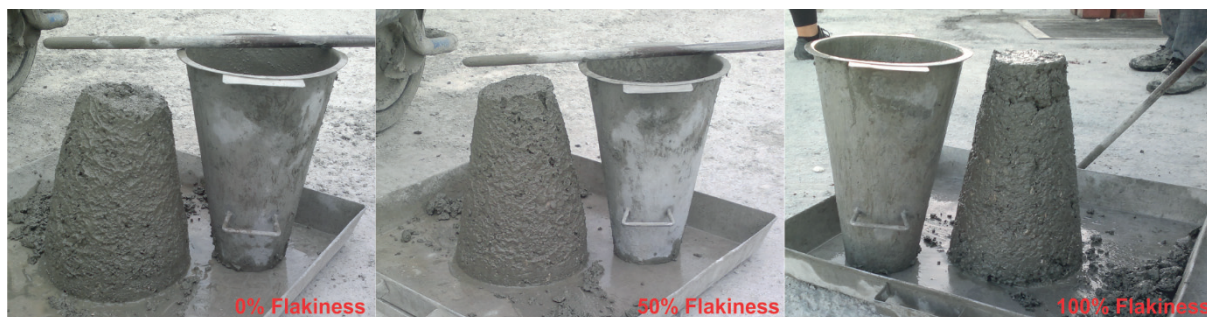
Rys. 3. Opad stożka mieszanki betonowej z 50 i 100% udziałem kruszywa płaskiego
