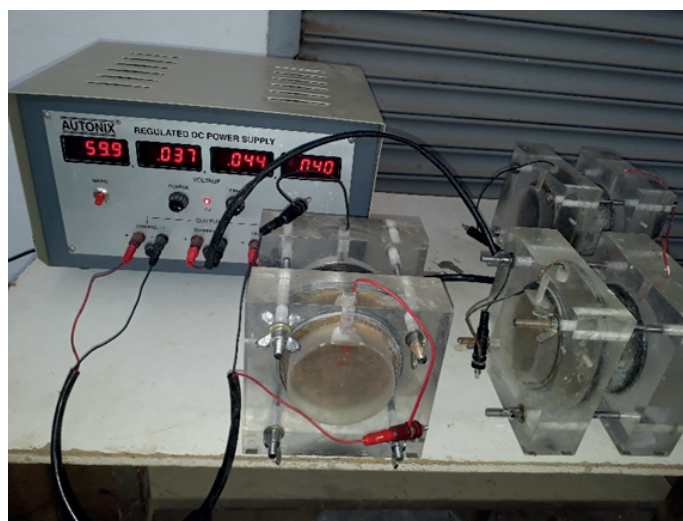
Rys. 1. Stanowisko do szybkiego badania przepuszczalności chlorków
