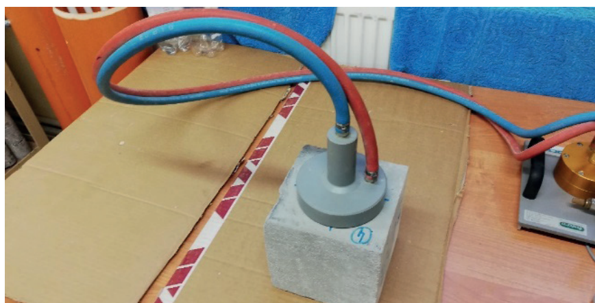
Rys. 2. Badanie przepuszczalności powietrza
