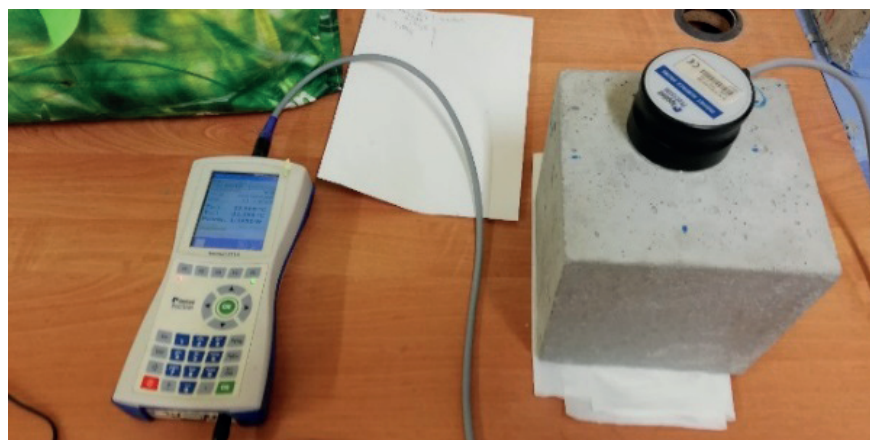
Rys. 3. Pomiar właściwości cieplnych Fig. 3. Thermal parameters test setup
