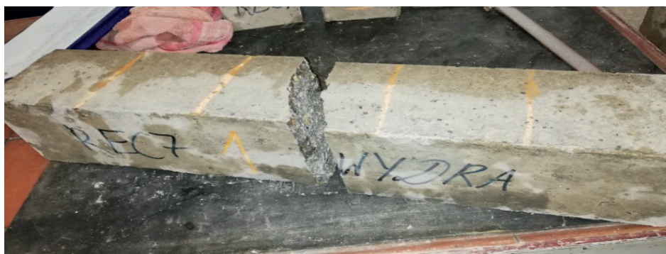
Rys. 1. Próbką po zniszczeniu – badanie wytrzymałości na zginanie
