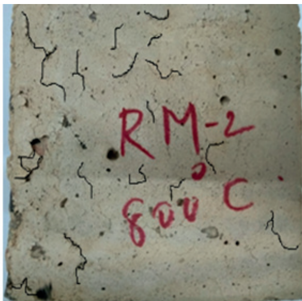
Rys. 4. Próbką betonu MŻ poddanego działaniu temperatury 800°C
