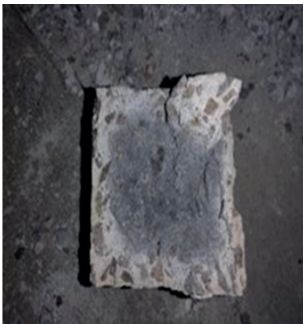
Rys. 6. Próbką betonu BC poddanego działaniu temperatury 800°C
