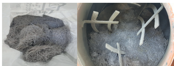
Rys. 1. Zbrojenie włóknami w mieszance betonowej
