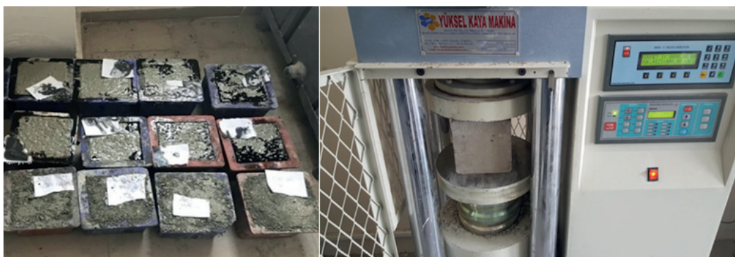
Rys. 2. Przygotowanie i badanie próbek sześciennych
