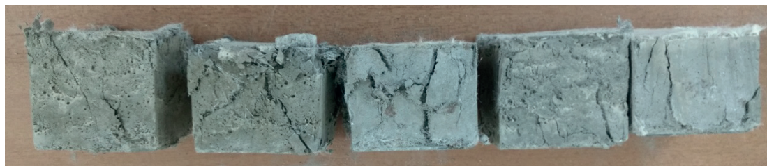
Rys. 6. Zniszczenie wraz z odkształceniem plastycznym próbek z WPW i zbrojeniem hybrydowym
