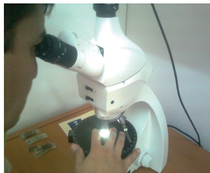
Rys. 6. Mikroskop stosowany w analizie cienkich próbek
