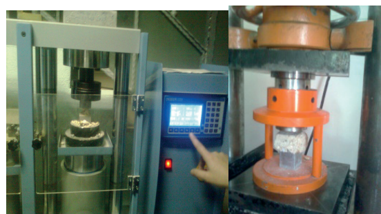
Rys. 7. Prasa hydrauliczna użyta do badania próbek zapraw
