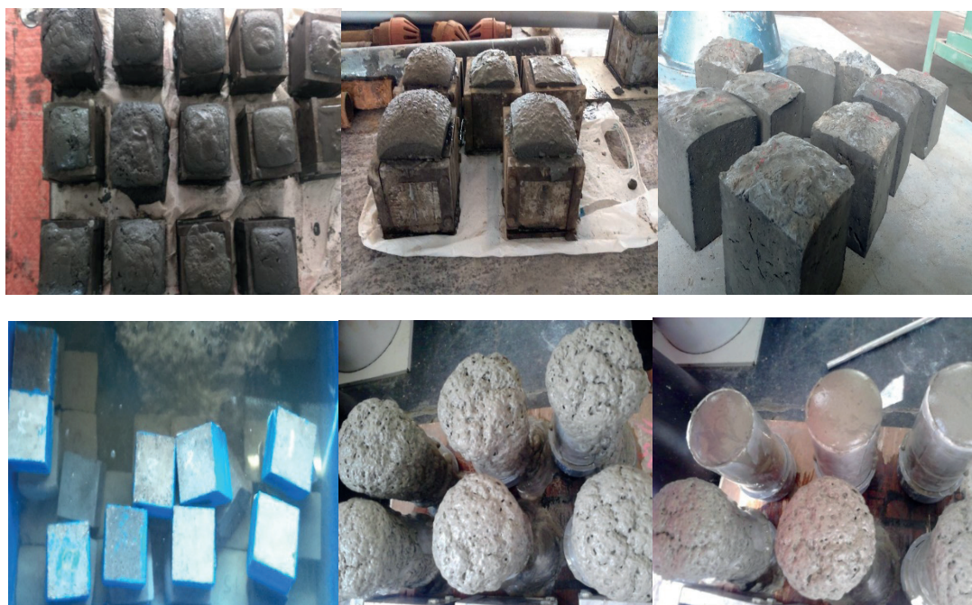
Rys. 7. Przygotowanie, formowanie i twardnienie próbek
