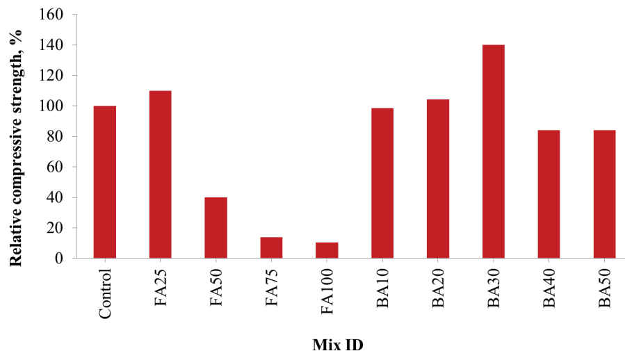
Rys. 25. Względna wytrzymałość na ściskanie CM 1:2, po 7 dniach
