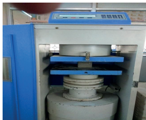
Rys. 8. Stanowisko do badania wytrzymałości na ściskanie kostek
