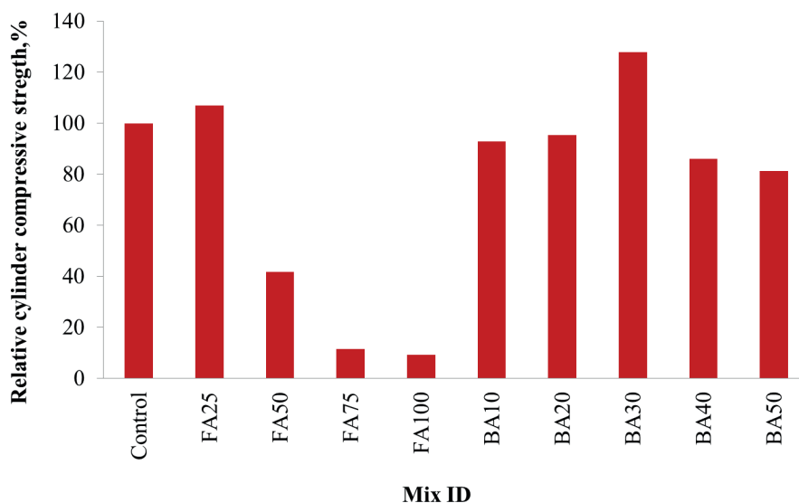
Rys. 37. Względna wytrzymałość na ściskanie walca z betonu lekkiego CM 1:3, po 28 dniach
