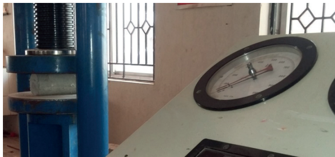
Rys. 10. Stanowisko doświadczalne do pomiaru wytrzymałości na rozciąganie przy rozłupywaniu
