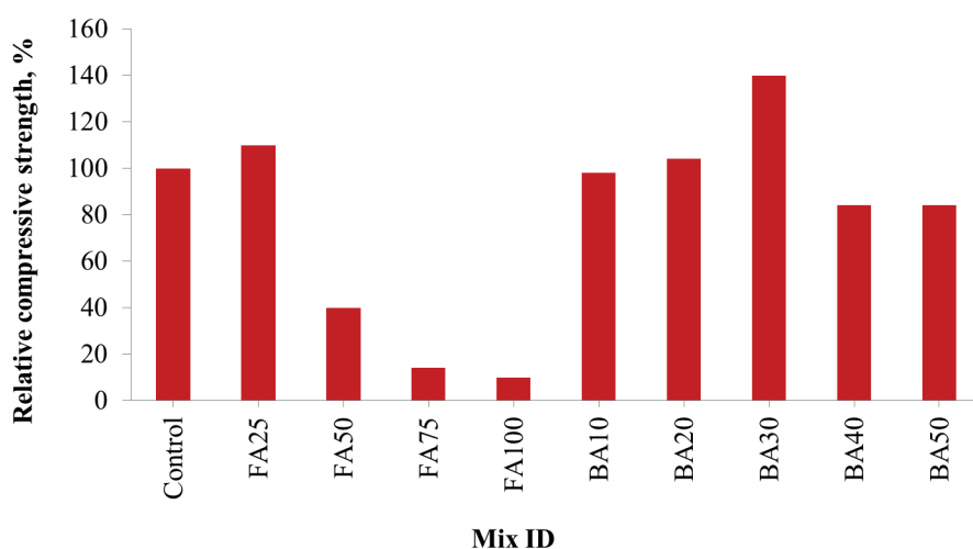
Rys. 27. Względna wytrzymałość na ściskanie CM 1:2, po 28 dniach
