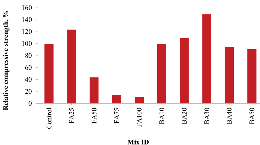
Rys. 21. Względna wytrzymałość na ściskanie CM 1:1 po 28 dniach
