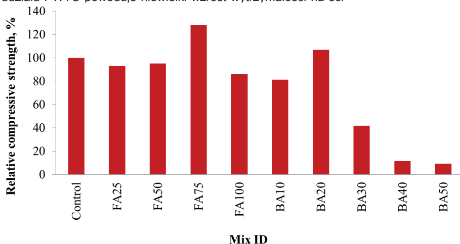
Rys. 33. Względna wytrzymałość na ściskanie CM 1:3, po 28 dniach
