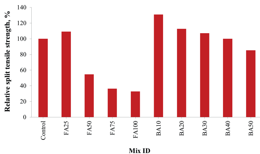
Rys. 39. Względna wytrzymałość na rozciąganie przy rozłupywaniu CM 1:2 po 28 dniach
