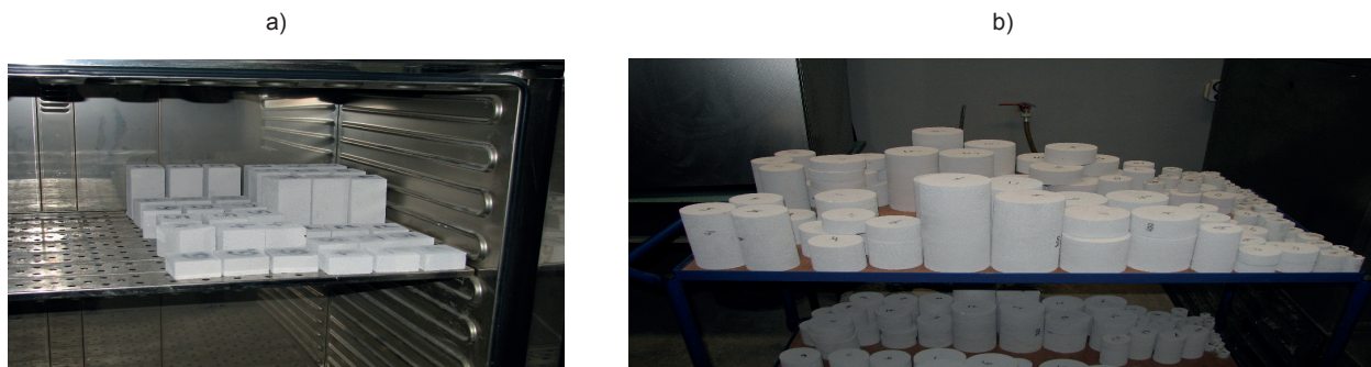
Rys. 1. Widok próbek wykorzystanych w badaniach wpływu kształtu: a) próbki prostokątne w trakcie suszenia, b) próbki walcowe, przygotowane do suszenia
