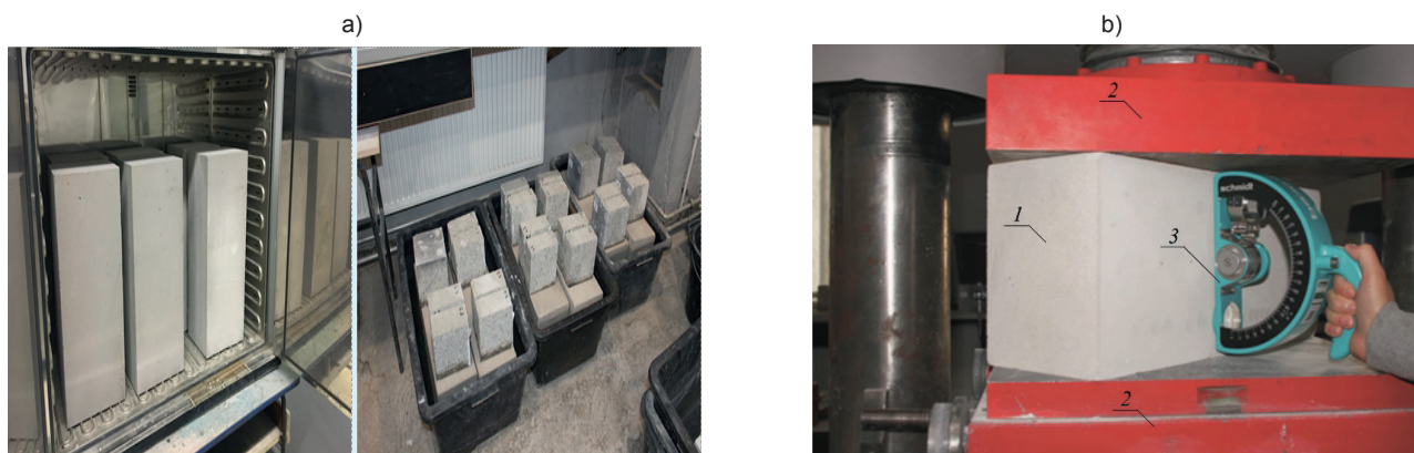
Rys. 8. Badania sklerometryczne ABK: a) widok próbek z ABK – 180×240×560 mm w trakcie suszenia, b) badania liczby odbicia w maszynie wytrzymałościowej; 1 – badana próbka z ABK, 2 – głowice maszyny wytrzymałościowej, 3 – wahadłowy młotek Schmitda typu OS-120PT
