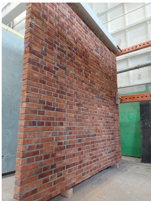
Rys. 9. Ściana trójwarstwowa z elewacją ceglana [fot. Pekabex]
