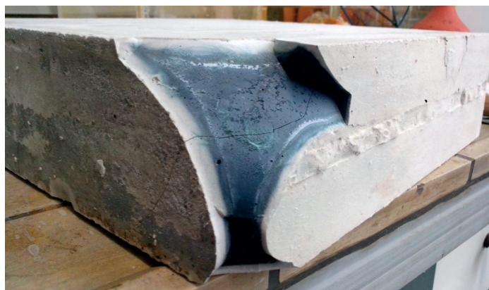
Rys. 2. Próbkę z zaczynu żuźlowego po 19 dobach korozji w roztworze \text{NH}_4\text{Cl} , po wykonaniu przełamu
